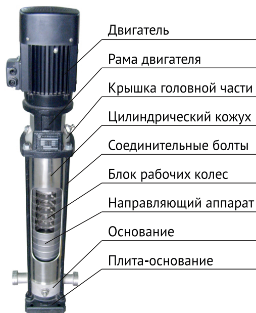
Рис.2. Конструкция насосов
